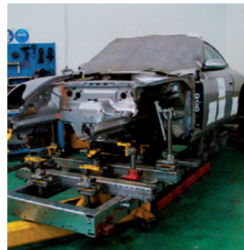
Richtbank zur Unfallinstandsetzung Fahrzeug wird millimetergenau vermessen
